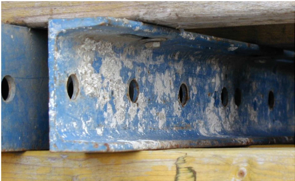
Afbeelding 7: toelaatbare betonresten op stalen gordingen
