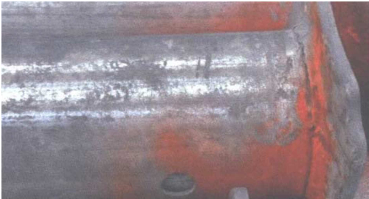
Afbeelding 13: ontoelaatbare scheur in lasnaad
