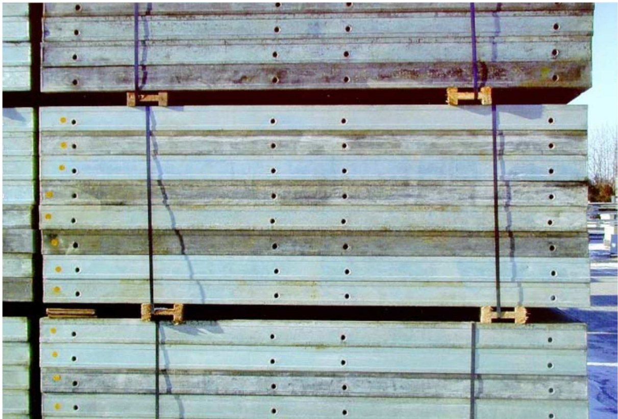
Afbeelding 3: voorbeeld van de voorgeschreven reinigingstoestand voor contactvlakken
