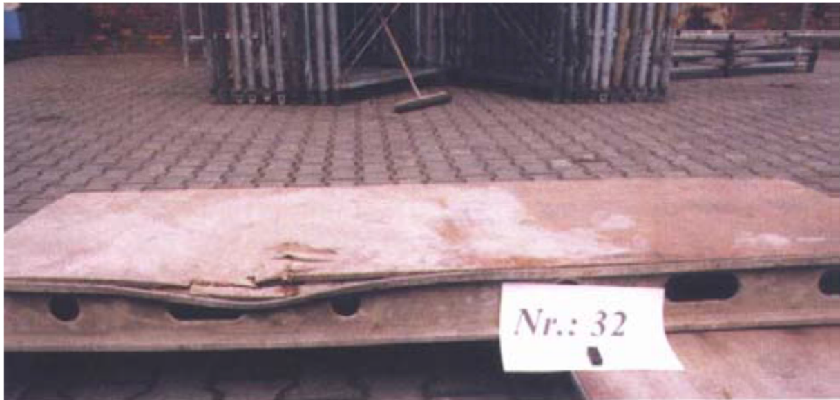
Afbeelding 20: ontoelaatbare beschadiging aan frameprofiel
