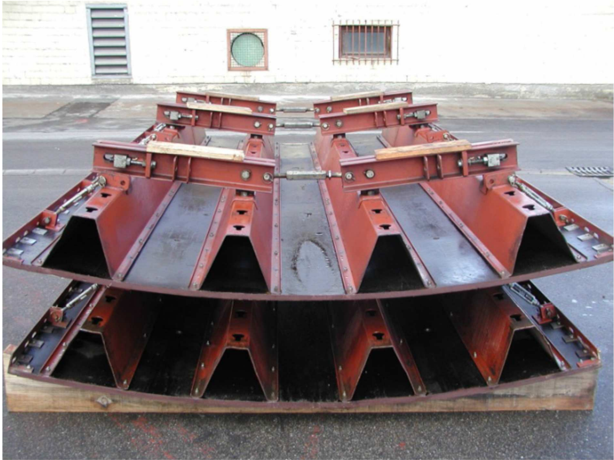
Afbeelding 9: het gebruik van houten uitvullingen voor de opslag van bekistingspanelen
