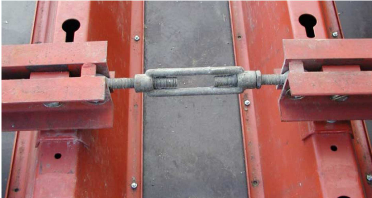
Afbeelding 8: voorbeeld van een spindel in bruikbare staat
