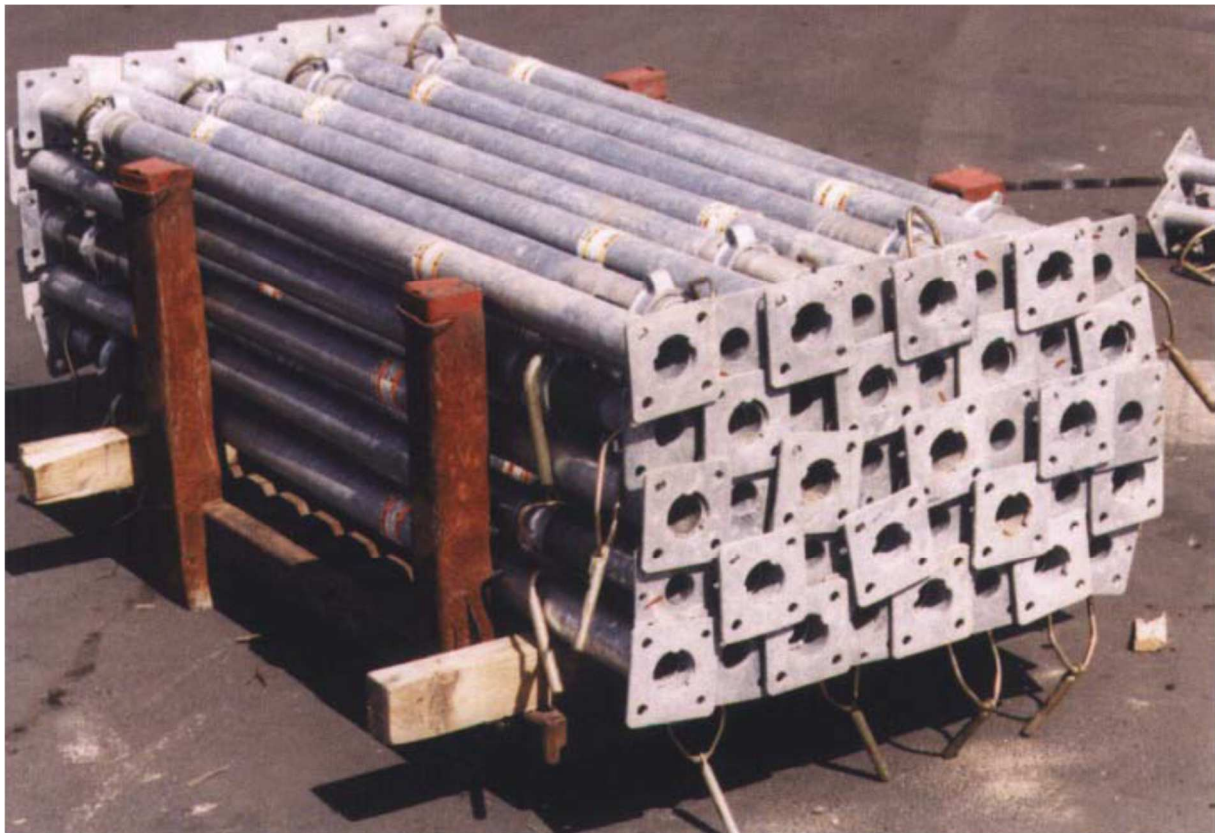
Afbeelding 10: gebruikte schoren, voldoen aan reinigingstoestand
